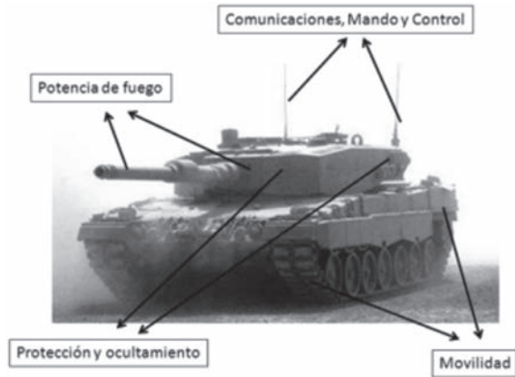
Figura 1 Elementos fundamentales en la composición de un vehículo de combate
