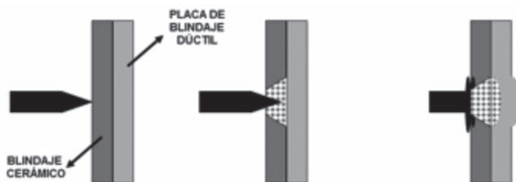
Figura 5 Funcionamiento del blindaje cerámico
